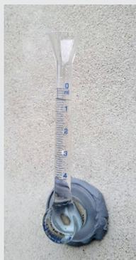
**Wasserabweisende Wirkung** geprüft nach *UNI EN 16302:2013* Messung der Wasseraufnahme durch Prüfröhr (Karsten-Röhr). PW10 reduziert die Wasseraufnahme um bis zu 95 %.
