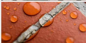
SALVATERRAZZA® crea una resistencia en las grietas y en las fisuras de materiales y juntas, evitando la penetración del agua y su consecuente filtración.
