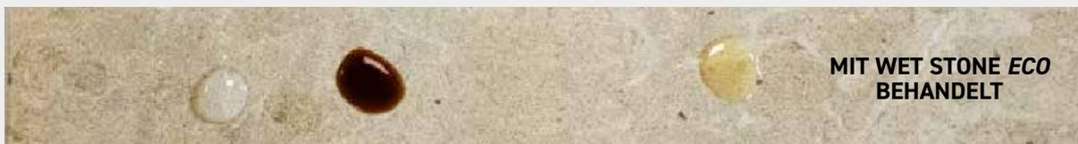
**UV-beständig, vergilbt nicht.** Beschleunigte Alterung durch UV-Bestrahlung ASTM G154. Farbveränderung geprüft nach UNI EN 15886:2010 Messung der Oberflächenfarbe.
